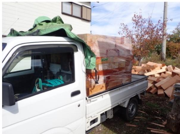
フトで荷台に積み込むと10cmぐらい沈み込み。バランスが悪いとハンドルが軽くなり、ローリングしてしまうので積む位置が重要なのです、少し前に積むのがコツです。今回は4パレット一回運ぶのに1時間かかるので、運搬作業は午後までかかりそうです。そして、スピードも50km以上になると急に止まれないので慎重に、慎重に神経を使って運転しなくてはなりません。端材は桧や杉などの高級材ばかりでもちろん乾燥していますから良く燃えます。この量で来年秋までは十分な量だそうです。かなり大きな梁材などもあるので、薪割り仕事も重労働です。
